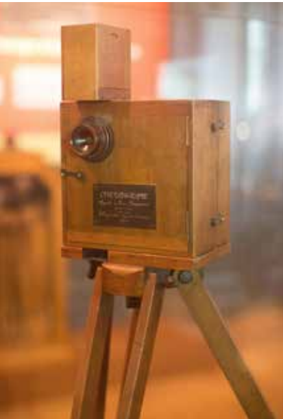
הסינמטוגרף של האחים לומייר – מצלמה ששימשה גם כמכשיר הקרנה ופיתוח בעידן הראינוע
